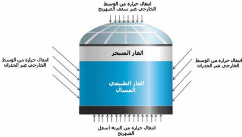
الشكل 1-32: انتقال الحرارة من الوسط الخارجي إلى صهريج تخزين الغاز الطبيعي المسال
