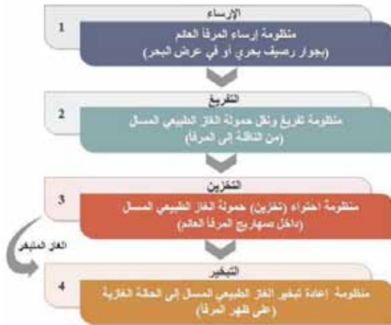
الشكل 1-47: سير عمليات المرافق العائمة
